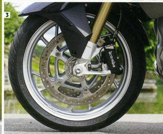
**1. Das Cockpit** ist grosszügig und übersichtlich gestaltet. **2. Jetzt werkelt** auch in der RT der vor einem Jahr in der R 1200 GS eingeführte **Boxer mit Präzisions-Wasserkühlung**. **3. Brembo-Stopper** mit **ABS**.
