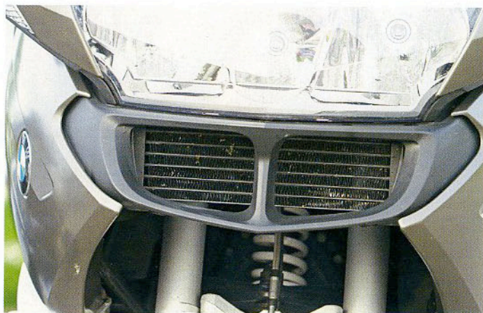
BMW-typisch: nierenförmig verblendeter Ölkühler unter dem Scheinwerfer
