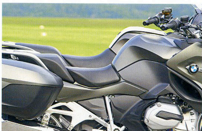
Zwei Zentimeter tiefergelegt: vorn die neue, hinten die alte RT
