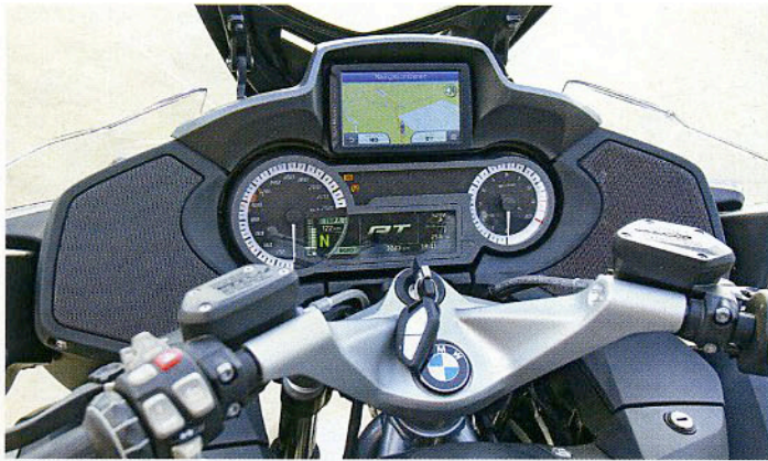
RT-Cockpit 2014: zentraler Digitalmonitor, darüber Navigation (optional)
