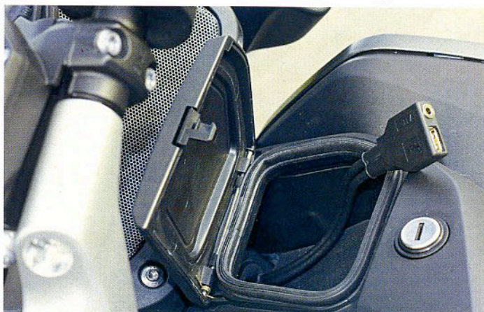
Auf dem neuesten Stand: USB-Kabel im kleinen Fach über dem Kühler
