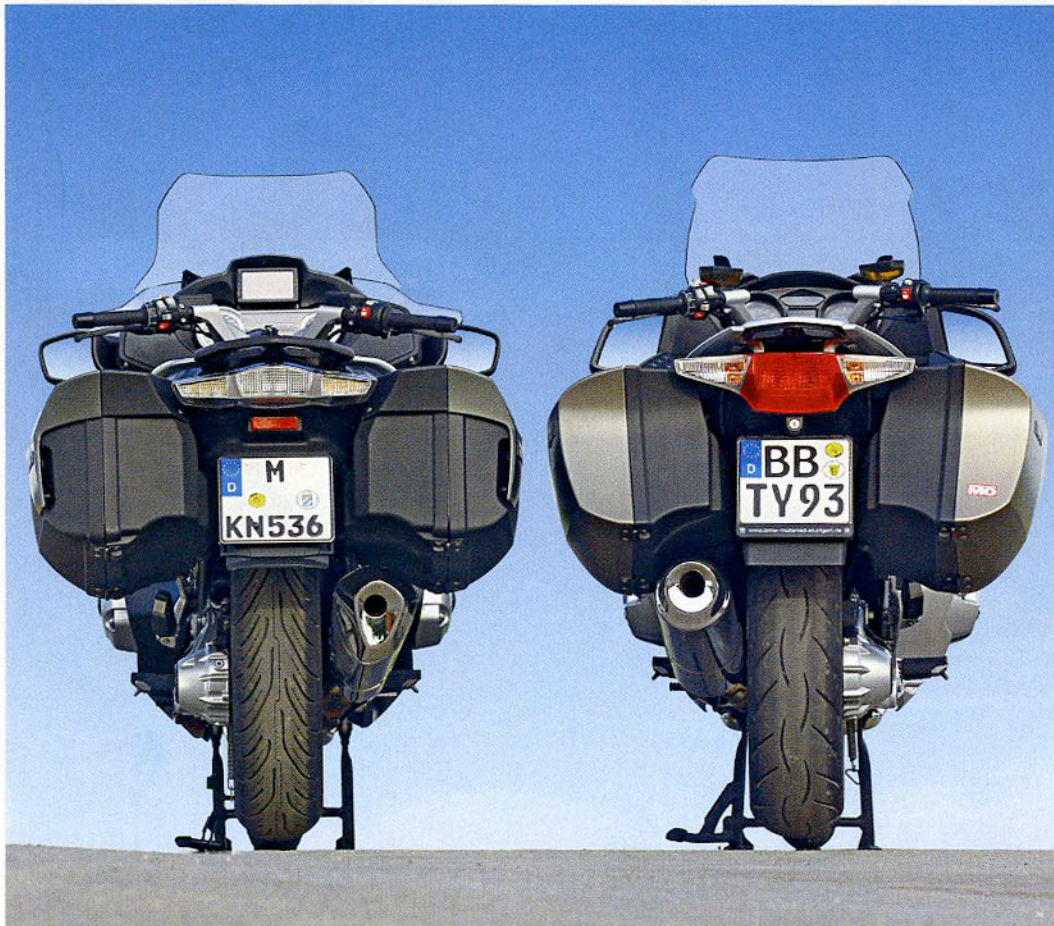
Hier steht die Neue links, die Ältere rechts. Leicht zu erkennen an Kardan und Auspuff – getauschte Position
